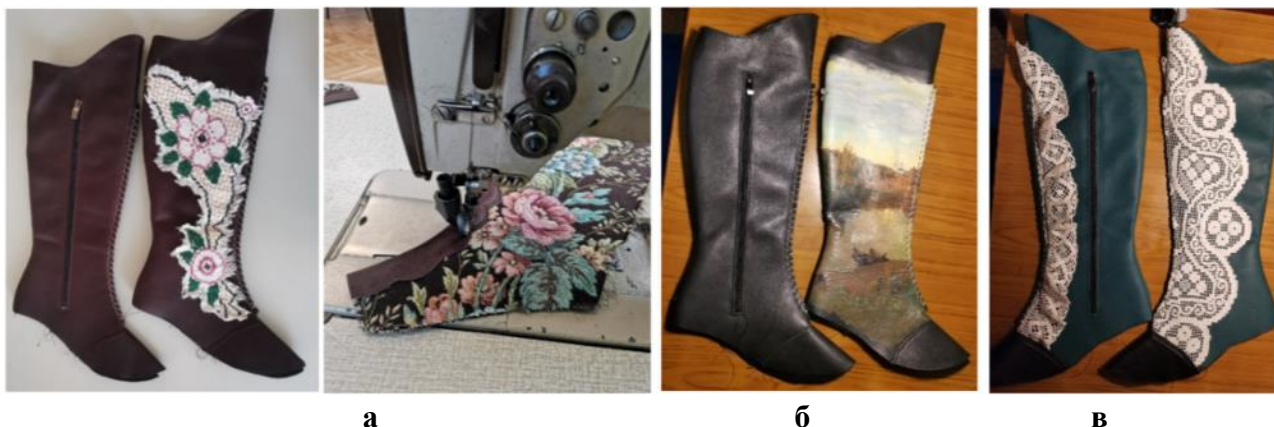
Рис. 2. Заготовки сапожек, декорированные: гобеленом (а), ручной росписью (б), винтажным кружевом (в), архив кафедры ХМКиТИК, автор Турчина Ю.
