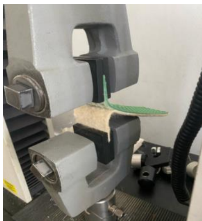
Рис. 1. Испытание на расслаивание пакета материалов войлок с ТПУ Flex на INSTRON 4411
