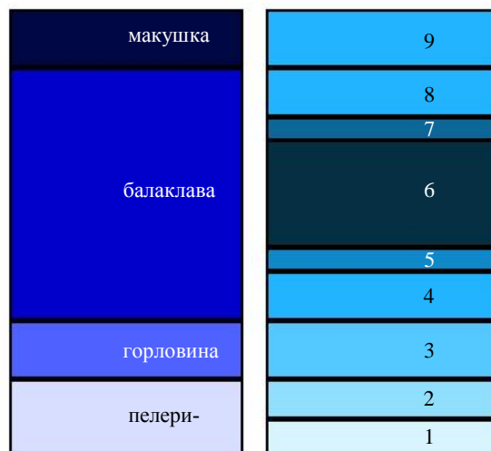
Рис. 3. Технический эскиз по зонам вязания с переплетениям: 1 – фанг; 2 – полуфанг; 3 – ластик 2+2, неполная гладь; 4,8,9 – ластик 2+2; 5,7 – про- изводная гладь; 6 – ластик 2+2, производная гладь
