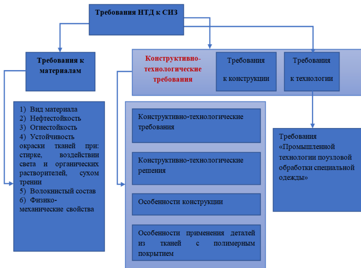
Рис. 3. Схематическое изображение требований НТД к специальной одежде работников нефтегазового промысла
